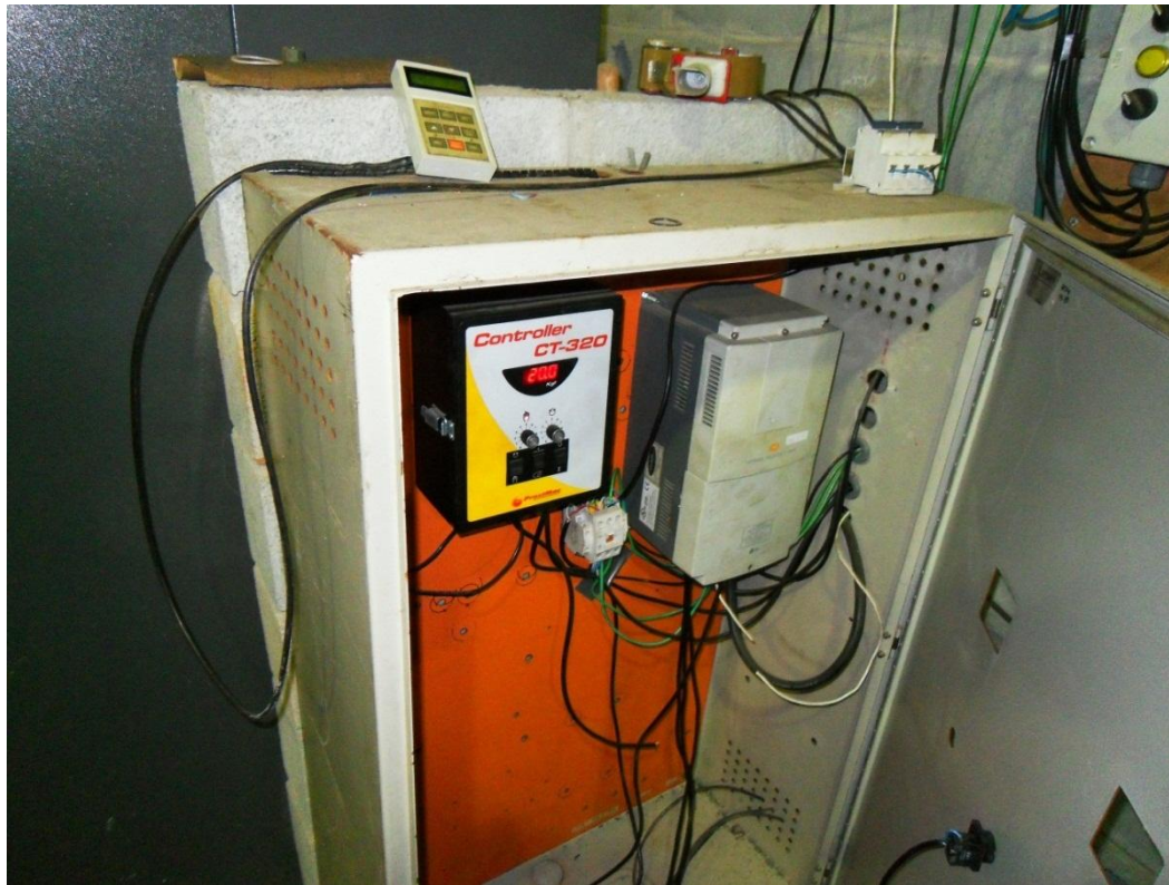
Fig 3.11 – Quadro de comando do inversor do rebobinador e controle de tensão da célula de carga
