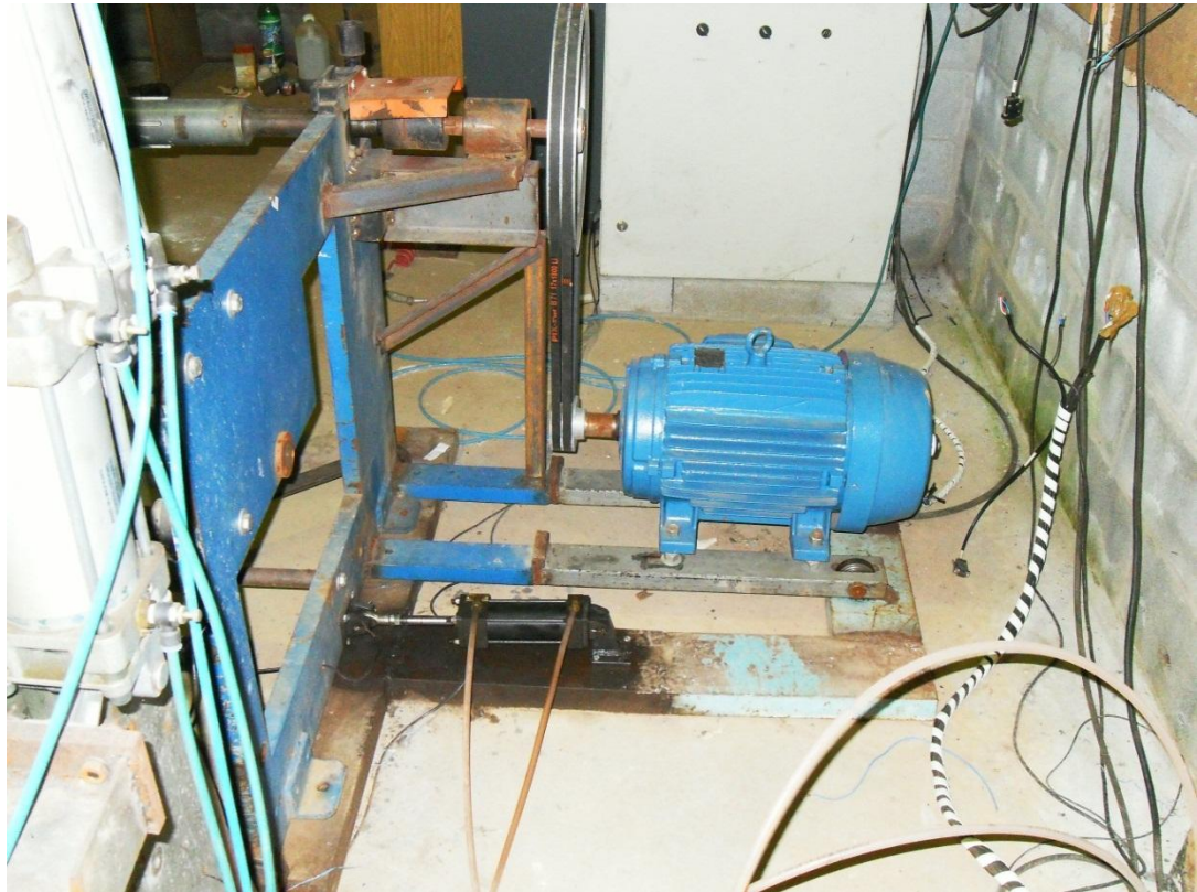
Fig 3.9 – Motor do rebobinador sobre rolimãs e pistão hidráulico do alinhador lateral.
