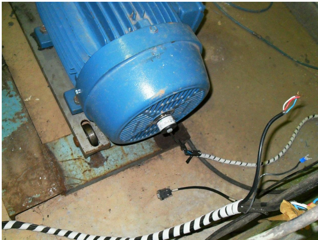
Fig 3.8 – Detalhe do encoder do motor do rebobinador
