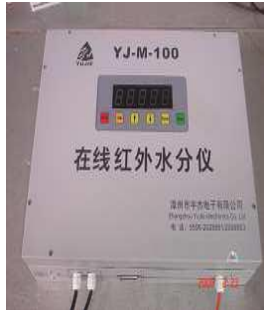
Fig 4.6 – Fotos do sensor infravermelho e da unidade de controle. Extraído de [7].
