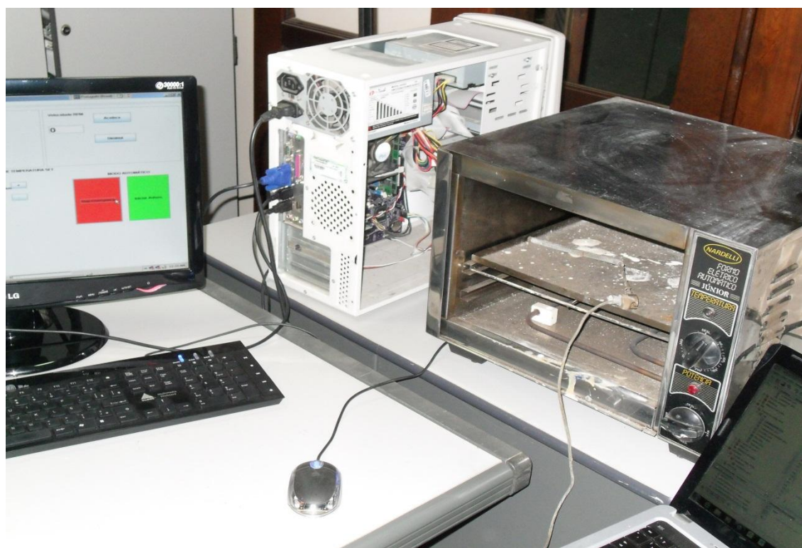
Fig 6.16 – PC e forno elétrico com termopar, simulando o forno do coater.
