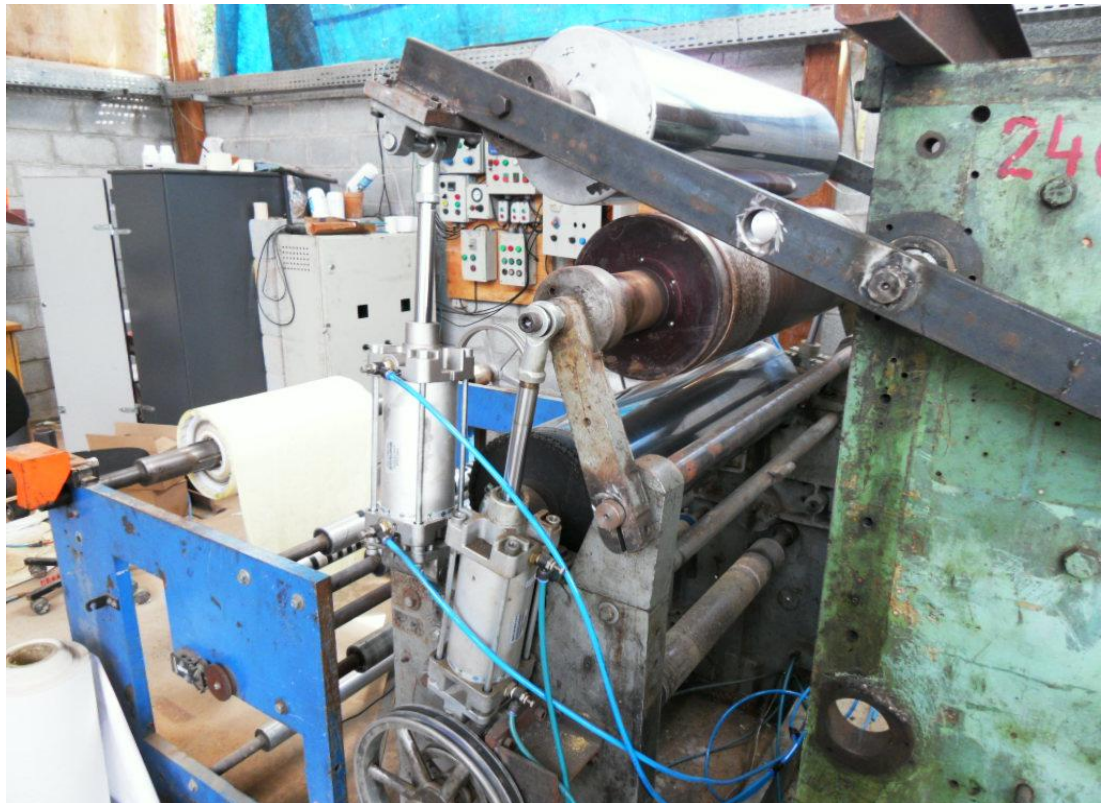
Fig 3.6 – Detalhe da calandra com pistões pneumáticos
