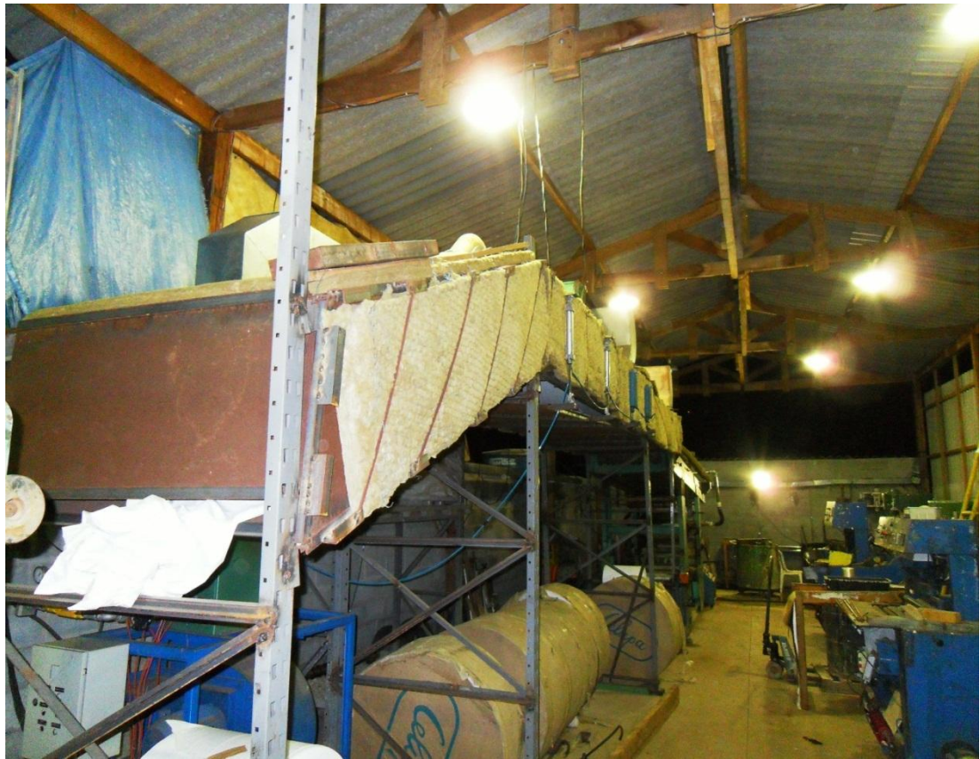
Fig 3.4 – Túnel de secagem – comprimento: 20 metros
