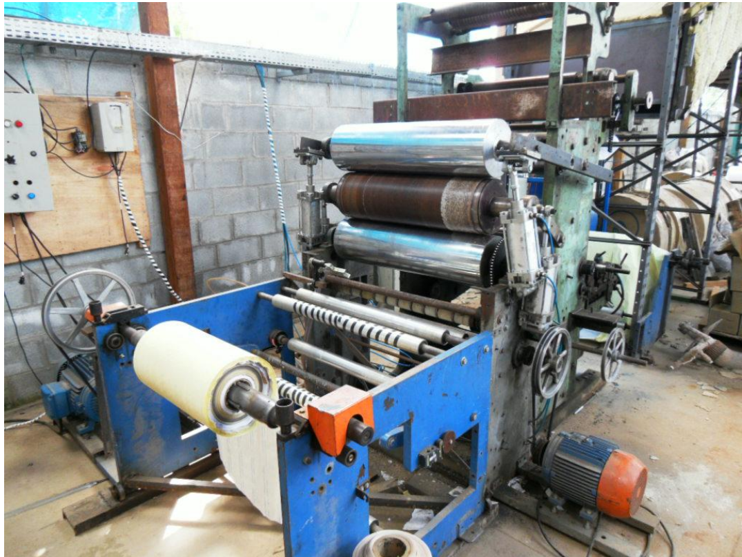
Fig 3.5 – Calandra, motor de acionamento e cavalete rebobinador
