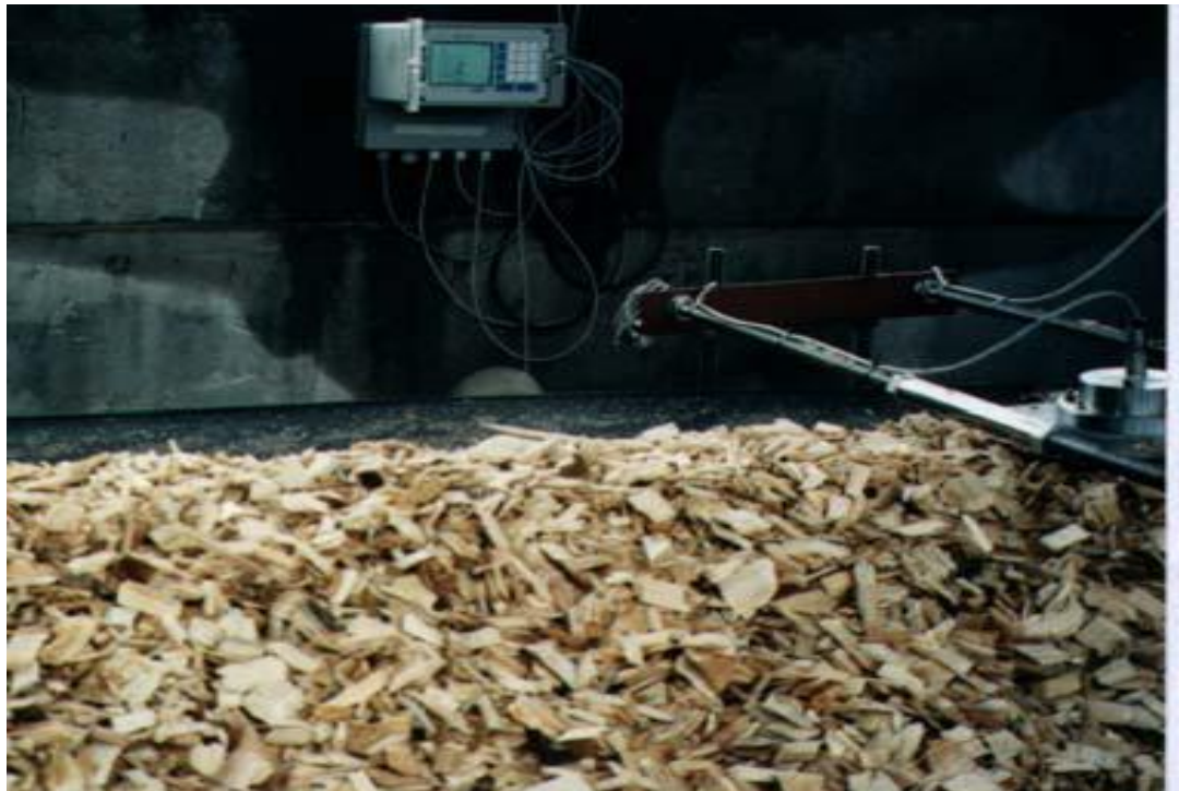
Fig 4.1- Sensor de microondas monitorando a umidade de madeira. Extraído de [5].
