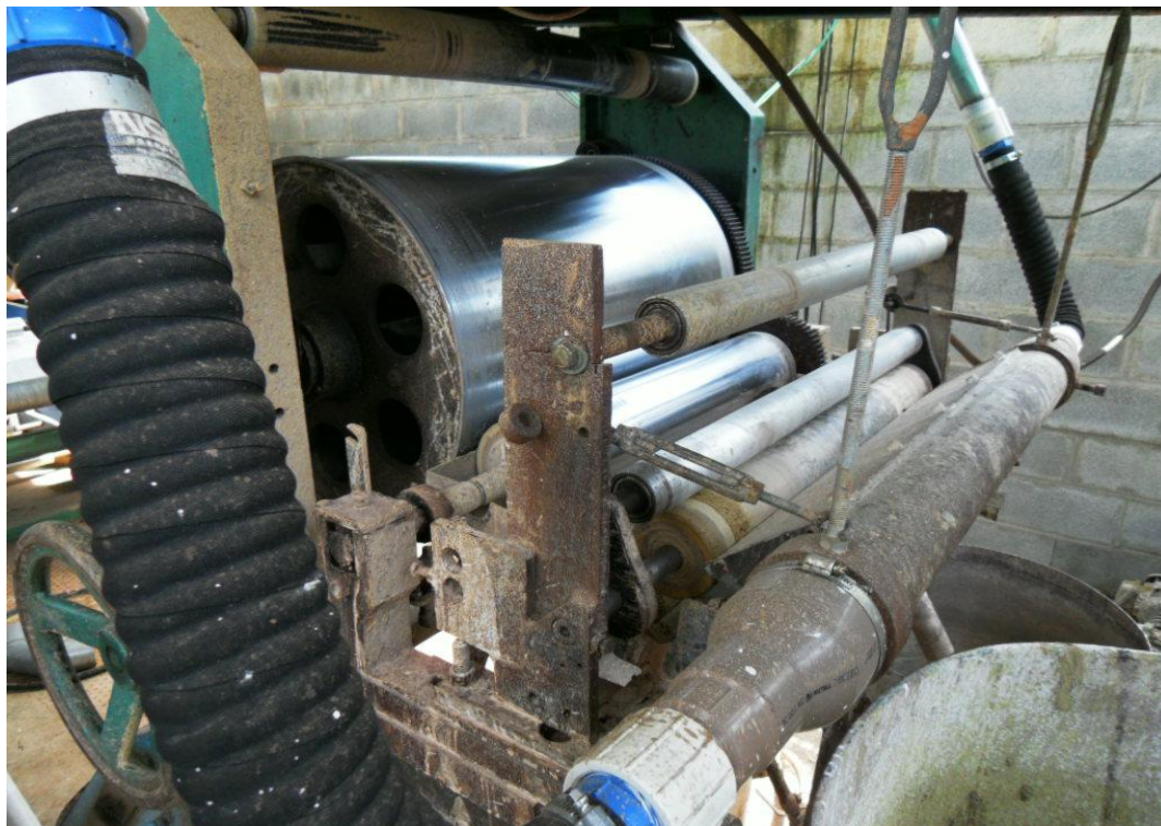
Fig 3.2 – Estação de aplicação e dosagem da tinta de revestimento
