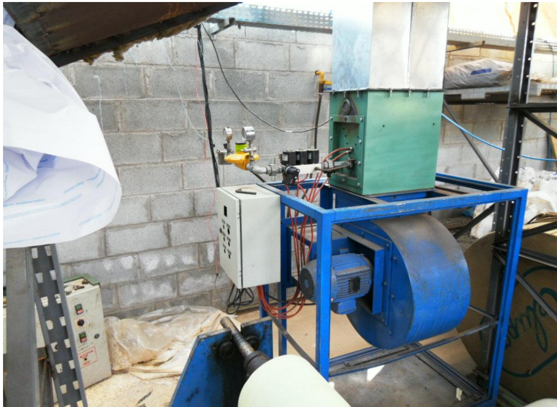
Fig 3.3 – Queimador principal – capacidade 220.000 Kcal/h
